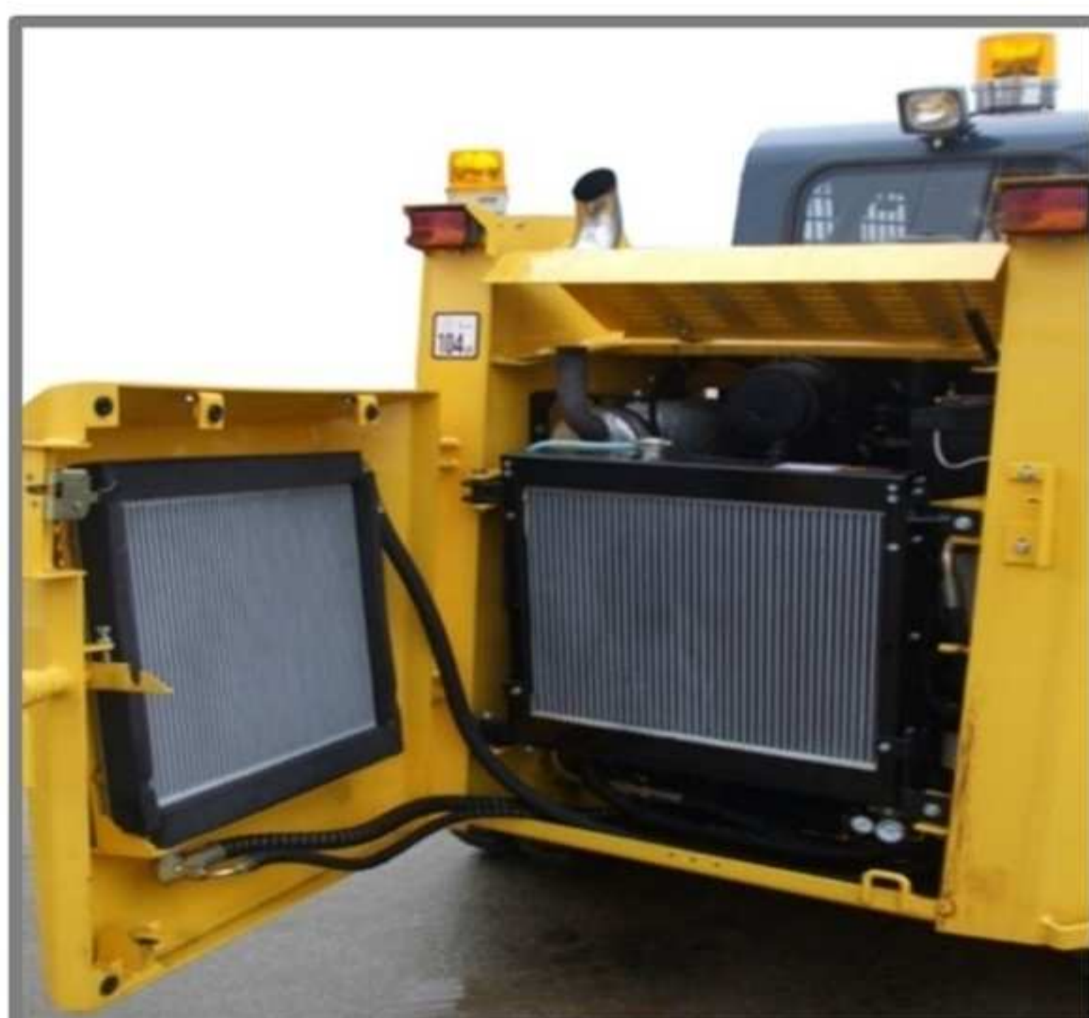
Wasser- und Ölkühler
